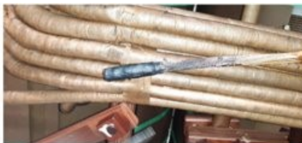
Figura 10: Detalhe da luva de compressão carbonizada 2.
